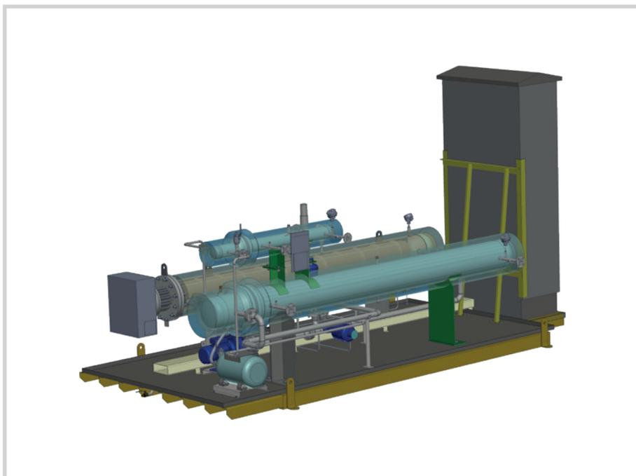
Zoppas Industries fornisce scambiatori di calore, pannelli di controllo, pompe, valvole e altri dispositivi a richiesta montati su skid che vengono impiegati nei processi di trasferimento del calore.
